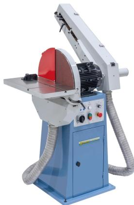
Die Bernardo BTS 510 Vario Band- und Tellerschleifmaschine ist eine leistungsstarke Maschine für die Schleifarbeiten. Der Schleiftisch ist unterhalb der Mitte montiert, um eine optimale Schleifscheibenausnutzung zu ermöglichen. Die Maschine verfügt über einen Frequenzumrichter zur stufenlosen Drehzahlregelung, ideal zur Anpassung an das jeweilige Werkstück.
