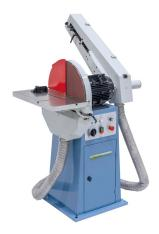
Die Bernardo BTS 510 Vario Band- und Tellerschleifmaschine ist ein vielseitiges Werkzeug für verschiedene Schleifanwendungen. Die Maschine verfügt über eine Bandabmessung von  $2000 \times 50$  mm und einen Schleifteller mit 500 mm Durchmesser. Der Tisch ist 635 x 305 mm groß und kann zwischen 0° und +45° geschwenkt werden.
