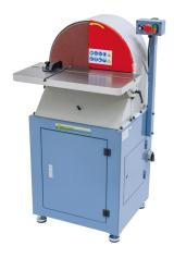
Die Tellerschleifmaschine TS 510 Vario ist zum Schleifen von Holz, Kunststoffen, Stahl und NE-Metallen bestens geeignet. Durch die serienmäßige Klettauflage können die Schleifscheiben ohne Werkzeug einfach und schnell gewechselt werden.
