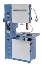
Die Vertikalbandsägen der VBS-Serie eignen sich zum Sägen von nahezu allen sägbaren Materialien (zB. Stahl, Kunststoff, NE-Metalle, Buntmetalle, ...). Ihren Einsatzbereich finden sie vorwiegend in der allgemeinen Produktion, im Werkzeug- und Vorrichtungsbau, bei der Herstellung von Stanz- und Schnittwerkzeugen.
