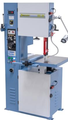
Die Vertikalbandsägen der VBS-Serie eignen sich zum Sägen von nahezu allen sägbaren Materialien (zB. Stahl, Kunststoff, NE-Metalle, Buntmetalle, ...). Ihren Einsatzbereich finden sie vorwiegend in der allgemeinen Produktion, im Werkzeug- und Vorrichtungsbau, bei der Herstellung von Stanz- und Schnittwerkzeugen.
