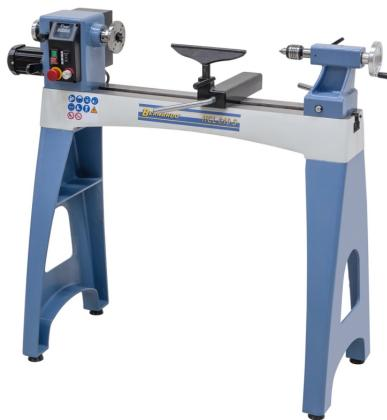
Die Drechselmaschine HCL 610 S gewährleistet durch ihre stabile Graugusskonstruktion ein vibrationsfreies und genaues Arbeiten. Durch die großzügige Grundausstattung (LED-Anzeige, stufenlose Drehzahlregelung, ...) ist dieses Modell die ideale Lösung für professionelle Heimwerker:
