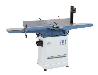
Die Abrichthobelmaschine SP 200 PS ist das ideale Einsteigermodell zum plangenauen Abrichten, Fügen und Anfasen von Brettern, Leisten, Balken, usw. Die schwere Gussausführung und die präzise Konstruktion erfüllen die hohen Ansprüche der ambitionierten Heim- und Handwerker.
