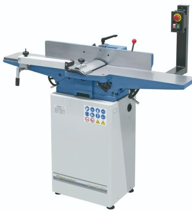
Die Abrichthobelmaschine SP 150 PN ist das ideale Einsteigermodell zum plangenaugen Abrichten, Fügen und Anfasen von Brettern, Leisten, Balken, usw. Die schwere Gussausführung und die präzise Konstruktion erfüllen die hohen Ansprüche der ambitionierten Heim- und Handwerker.
