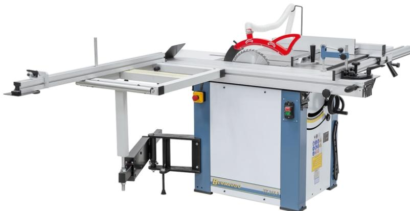
Die Formatkreissäge TK 315 P ist je nach Anwendung wahlweise mit drei verschiedenen Tischlängen lieferbar (1600 / 1800 / 2000 mm). Serienmäßig ausgestattet mit einem 3,0 kW Motor und einem Sägeblatt mit 315 mm Durchmesser für Schnitthöhen bis 100 mm, sowie einem Vorritzagggregat für ein ausreißfreies Bearbeiten beschichteter Plattenwerkstoffe.
