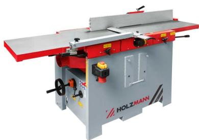
Die Holzmann HOB410PROSMW4\_400V Hobelmaschine mit Spiralmesserwelle ist eine hochwertige und qualitative Verarbeitung. Der Abrichttisch ist klappbar und platzsparend, der Graugusstisch hat eine geschliffene Oberfläche. Der stabile Profi-Abrichtanschlag ist schwenkbar von 90-45°. Die einstellbaren Dickenbeschleunigungen gewährleisten optimalen Werkstücktransport. Die spiralförmig verzahnte Einzugswalze sorgt für perfekten Werkstücktransport.
