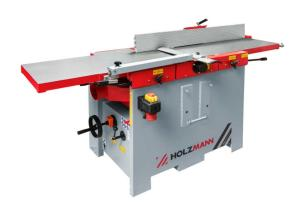
Abrichttisch ist klappbar und platzsparend, der Graugusstisch hat eine geschliffene Oberfläche. Der stabile Profi-Abrichtanschlag ist schwenkbar von 90-45°. Die einstellbaren Dickentischwalzen gewährleisten optimalen Werkstücktransport. Die spiralverzahnte Einzugswalze sorgt für perfekten Werkstücktransport.
