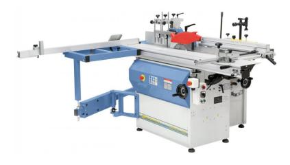
Die Universal-Kombinationsmaschine CWM 310 F bietet dem Anwender durch die vielfältigen Einsatzmöglichkeiten ein optimales Preis-Leistungsverhältnis. Der Formattisch mit 2000 mm Länge, das serienmäßige Vorritzaggregat und die 3 Spindelgeschwindigkeiten sind weitere Argumente die für dieses Modell sprechen.
