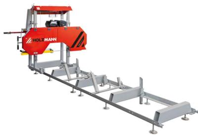
Die HOLZMANN Blochbandsäge BBS810SMART-G ist ideal zum Schneiden von weichem, hartem, trockenem oder gefrorenem Holz bzw. Holzprismen mit einer Länge entsprechend der Maschinenkonstruktion. Dank des leistungsstarken Benzinmotors auch dort einsetzbar wo einmal keine Stromversorgung vorliegt.
