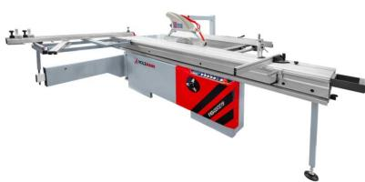
Die HOLZMANN Formatkreissäge FKS400V32TOP\_400 mit 3,2 m Schiebetisch, Vorrüster (Höhen und seitlich einstellbar), Hauptsägeblatt mit Höhen und Winkelverstellung, Tischverbreiterung, Auslegertisch - eine perfekte Säge für ihren Plattenzuschnitt in ihrer Tischlerwerkstatt.
