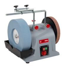
Das HOLZMANN Nass-Trocken-Schärfgerät NTS250S\_230V ist ideal zum Schleifen Ihrer Schnitz- und Drechselwerkzeuge, sowie Messern, Scheren und vielem mehr. Der Korund Schleifstein läuft durch eine Wasserwanne im Nassschleifbetrieb, um eine Überhitzung des Werkstücks zu verhindern. Die Drehzahl lässt sich bequem und stufenlos zwischen 90 und 150 min-1 einstellen.
