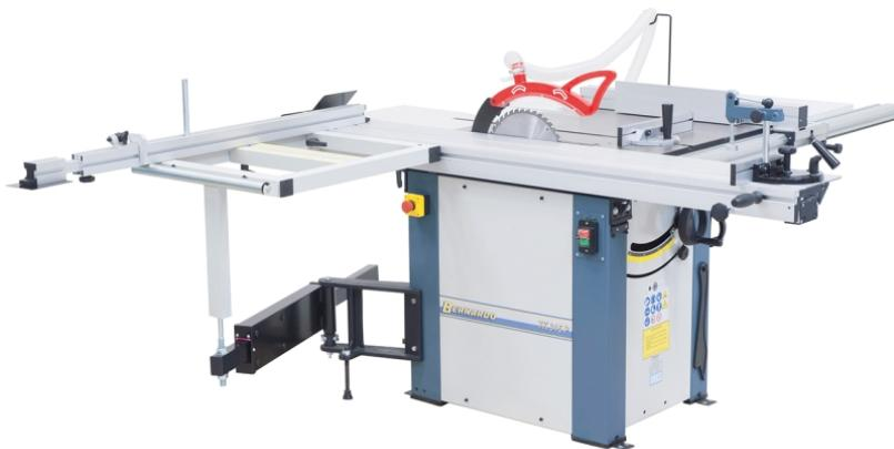
Die Formatkreissäge TK 315 P ist je nach Anwendung wahlweise mit drei verschiedenen Tischlängen lieferbar (1600 / 1800 / 2000 mm). Serienmäßig ausgestattet mit einem 3,0 kW Motor und einem Sägeblatt mit 315 mm Durchmesser für Schnitthöhen bis 100 mm, sowie einem Vorritzagggregat für ein ausreißfreies Bearbeiten beschichteter Plattenwerkstoffe.
