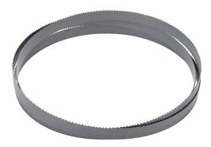
Das Bernardo Sägeband BiFlex 3960 x 34 x 1,4 - Vario 3/4 ZpZ Sägebänder Metallbandsägen ist ein hochwertiges Sägeband für Metallbandsägen. Die Abmessungen betragen 3960 x 34 x 1,1 mm. Das Sägeband ist aus BiFlex-Material gefertigt und hat eine Zähne pro Zoll-Zahl von Vario 3/4.
