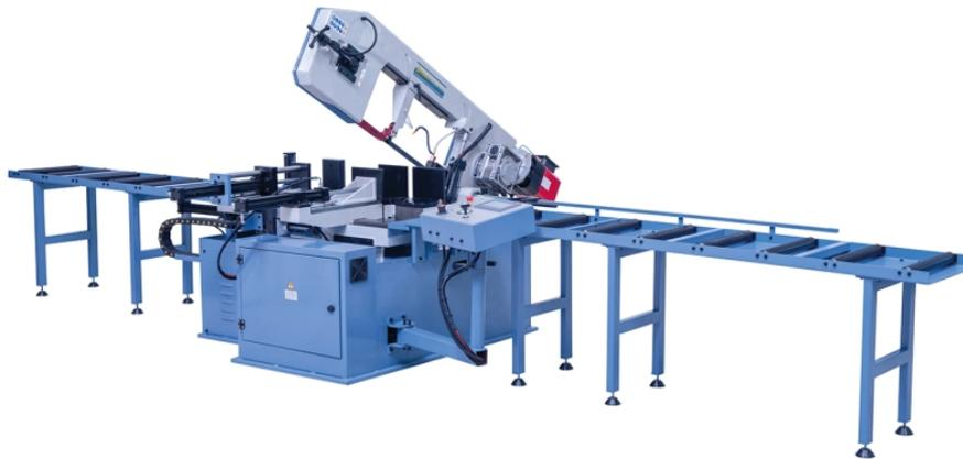
Das Modell CGS 330 VAG ist eine vollautomatische Gehrungsbandsäge (bis 60°) mit umfangreicher Ausstattung (wie z.B. PLC-Steuerung, stufenlose Bandgeschwindigkeit, automatische Bandbruchkontrolle,...). Die integrierte PLC-Steuerung ermöglicht ein vordefinieren der benötigten Stückzahl und Schnittlänge, wodurch eine wirtschaftliche Serienfertigung gewährleistet wird.
