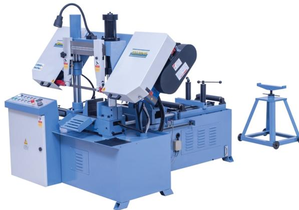
Das Modell CBS 280 VA ist eine vollautomatische Metallbandsäge mit dem wesentlichen Vorteil, dass die Zustellung des Sägerahmens über eine präzisionsgeschliffene Doppelsäulenführung erfolgt. Dadurch eignet sich diese Maschine ideal zum Bearbeiten von Blöcken aus Vollmaterial. Zusätzlich ist dieses Modell mit einer hydraulischen Bündelspaneinrichtung zum Schneiden von Materialpaketen ausgestattet.
