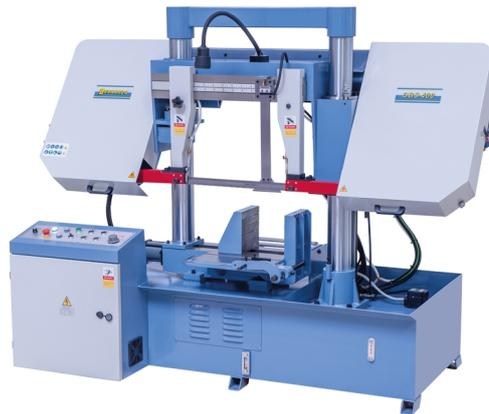
Die halbautomatische Doppelsäulen-Horizontalsäge CBS 400 hat den wesentlichen Vorteil, dass die Zustellung des Sägerahmens über eine präzisionsgeschliffene Säulenführung erfolgt. Dadurch eignet sich diese Maschine ideal zum Bearbeiten von Blöcken aus Vollmaterial. Zusätzlich ist dieses Modell serienmäßig mit einem Servomotor ausgestattet und bietet eine stufenlos einstellbare Schnittgeschwindigkeit.
