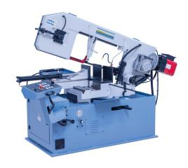
Das Modell DGS 460 HV ist eine kostengünstige Doppelgehrungsbandsäge zum Schneiden von Hohlprofilen, Vollmaterialien, Edelstahl, Werkzeugstahl usw. Die stufenlose Schnittgeschwindigkeit sowie der hydraulische Schraubstock ermöglichen ein komfortables Arbeiten. Durch die halbautomatische Funktionsweise wird die Produktivität zusätzlich erhöht und ist daher die ideale Maschine für Schlossereien, Maschinenbau, Formenbau, ...
