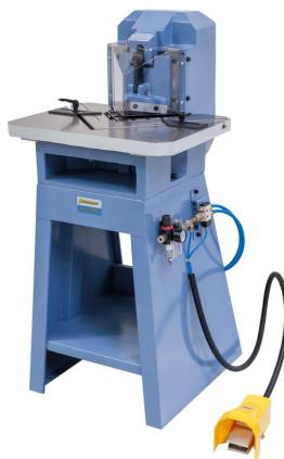
Die Bernardo AK 130 PT Pneumatische Ausklinkmaschinen ermöglichen das Ausklinken mit grätfreiem Schnitt, ohne Verformung der Schnittkanten. Der Maschinenkörper besteht aus hochwertigem Grauguss, das Untergestell aus Stahlblech. Das Schnittmesser ist aus oberflächengehärtetem Werkzeugstahl gefertigt.
