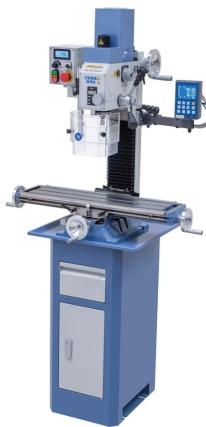
Die Bohr- und Fräsmaschine KF 25 L Vario ist bereits in der Grundausstattung mit einer digitalen Drehzahl- und Pinolenhubanzeige ausgestattet und bietet zusätzlich einen Verfahrtsweg in der x-Achse von 490 mm. Ihren Einsatzbereich findet diese Maschine beim professionellen Anwender, im Modellbau und im Ausbildungsbereich.
