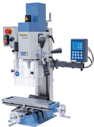
Die präzise Bohr- und Fräsmaschine KF 16 Vario ist für Bohr-, Frä- und Senkarbeiten bei kleinen Werkstücken bestens geeignet. Durch die kleine und vibrationsfreie Bauweise findet dieses Modell beim Bastler und Hobbyheimwerker ihren Einsatzbereich.
