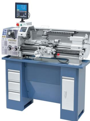
Die Drehmaschine Profi 650 G ist serienmäßig mit einer Leit- und Zugspindel zum Gewindeschneiden bzw. für den automatischen Längs- und Planvorschub ausgestattet. Durch das 12-Stufen-Schaltgetriebe wird ein schnelles Einstellen der Drehzahlen ermöglicht - kein Keilriemenwechsel notwendig. Durch ihre kompakte Bauweise und das hohe Eigengewicht bietet diese Maschine eine hohe Laufruhe und garantiert dadurch präzises Arbeiten.
