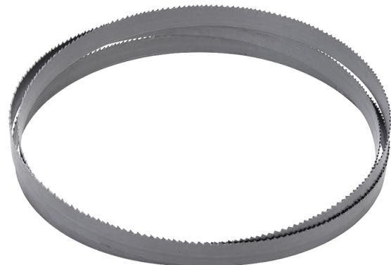
Das Bernardo Sägeband HSS 1735 x 20 x 0,8 - 14 ZpZ ist ein hochwertiges Sägebänder für Metallbandsägen. Es ist aus HSS (Hochgeschwindigkeitsstahl) gefertigt und weist eine Abmessung von 1735 x 20 x 0,8 mm auf. Das Sägebänder hat 14 Zähne pro Zoll.
