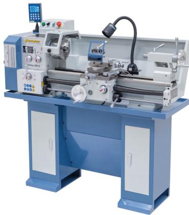
Die Drehmaschine Hobby 800 G ist serienmäßig mit einer Leit- und Zugspindel zum Gewindeschneiden bzw. für den automatischen Längs- und Planvorschub ausgestattet. Durch das 12-Stufen-Schaltgetriebe wird ein schnelles Einstellen der Drehzahlen ermöglicht - kein Keilriemenwechsel notwendig. Durch ihre kompakte Bauweise und das hohe Eigengewicht bietet diese Maschine eine hohe Laufruhe und garantiert dadurch präzises Arbeiten.
