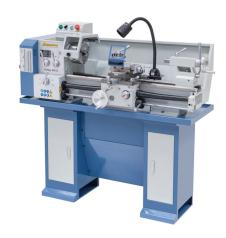
Die Drehmaschine Hobby 800 G ist serienmäßig mit einer Leit- und Zugspindel zum Gewindeschneiden bzw. für den automatischen Längs- und Planvorschub ausgestattet. Durch das 12-Stufen-Schaltgetriebe wird ein schnelles Einstellen der Drehzahlen ermöglicht - kein Keilriemenwechsel notwendig. Durch ihre kompakten Bauweise und das hohe Eigengewicht bietet diese Maschine eine hohe Laufruhe und garantiert dadurch präzises Arbeiten.
