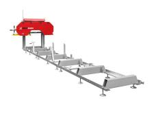
Die HOLZMANN Blochbandsäge BBS810SMART 400V ist ideal zum Schneiden von weichem, hartem, trockenem oder gefrorenem Holz bzw. Holzprismen mit einer Länge entsprechend der Maschinenkonstruktion.
