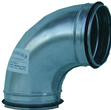
für Rohrdurchmesser 80 mm passend. Bogen 90 Grad mit integrierter Dichtung. Das preisgünstige Rohrsystem mit einfacher Montage! Die Absaugteile sind in verzinktem Blech mit 0,55 mm Stärke gefertigt. Die Verbindungsstücke mit integrierten Dichtungsringen garantieren eine einfache Montage. Das gesamte System ist in 3 Dimensionen lagernd 80/100/125 und 160 mm
