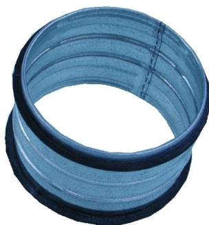
für Rohrdurchmesser 80 mm passend. Nippel mit integrierter Dichtung. Häufige Verwendung zum Verbinden von 2 Rohren! Das preisgünstige Rohrsystem mit einfacher Montage! Die Absaugteile sind in verzinktem Blech mit 0,55 mm Stärke gefertigt. Die Verbindungsstücke mit integrierten Dichtungsringen garantieren eine einfache Montage. Das gesamte System ist in 3 Dimensionen lagernd 100/125 und 160 mm
