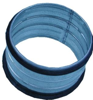
für Rohrdurchmesser 80 mm passend. Nippel mit integrierter Dichtung. Häufige Verwendung zum Verbinden von 2 Rohren! Das preisgünstige Rohrsystem mit einfacher Montage! Die Absaugteile sind in verzinktem Blech mit 0,55 mm Stärke gefertigt. Die Verbindungsstücke mit integrierten Dichtungsringen garantieren eine einfache Montage. Das gesamte System ist in 3 Dimensionen lagernd 100/125 und 160 mm
