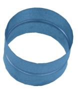
für Rohrdurchmesser 80 mm passend Muffe - wie ein kurzes Rohrstück Häufige Verwendung als Verbinder vom Abzweiger 45 Grad mit dem Bogen 45 Grad! Das preisgünstige Rohrsystem mit einfacher Montage! Die Absaugteile sind in verzinktem Blech mit 0,55 mm Stärke gefertigt. Die Verbindungsstücke mit integrierten Dichtungsringen garantieren eine einfache Montage. Das gesamte System ist in 3 Dimensionen lagernd 100/125 und 160 mm
