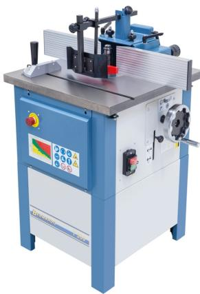
Bei der Entwicklung der Tischfräsmaschine T 500 wurde auf Sicherheit und einfache Handhabung größter Wert gelegt, um gute Arbeitsbedingungen und optimalen Bedienungskomfort zu gewährleisten. Die stabile Konstruktion aus Grauguss und Stahl gewährleistet auch auf Dauer hohe Fertigungsqualität und Präzision.
