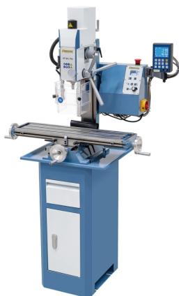
Die Bohr- und Fräsmaschine KF 26 L Top ist serienmäßig mit einem hochwertigem Gleichstrommotor ausgestattet. Wesentliche Vorteile, die sich daraus ergeben, sind das hohe Drehmoment im unteren Drehzahlbereich und die annähernd konstante Drehzahl unter Last. Ihren Einsatzbereich findet dieses Modell hauptsächlich beim professionellen Anwender, im Modellbau, aber auch im Ausbildungsbereich.
