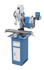
Die Bohr- und Fräsmaschine KF 26 L Top ist serienmäßig mit einem hochwertigem Gleichstrommotor ausgestattet. Wesentliche Vorteile, die sich daraus ergeben, sind das hohe Drehmoment im unteren Drehzahlbereich und die annähernd konstante Drehzahl unter Last. Ihren Einsatzbereich findet dieses Modell hauptsächlich beim professionellen Anwender, im Modellbau, aber auch im Ausbildungsbereich.
