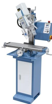
Die Bohr- und Fräsmaschine KF 26 L Top ist serienmäßig mit einem hochwertigem Gleichstrommotor ausgestattet. Wesentliche Vorteile, die sich daraus ergeben, sind das hohe Drehmoment im unteren Drehzahlbereich und die annähernd konstante Drehzahl unter Last. Ihren Einsatzbereich findet dieses Modell hauptsächlich beim professionellen Anwender, im Modellbau, aber auch im Ausbildungsbereich.
