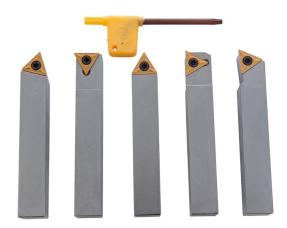
Der Bernardo Drehmeißelsatz mit HM-Wendeplatten ist ein 5-teiliger Satz, der für verschiedene Anwendungen geeignet ist. Die TiN-Beschichtung sorgt für eine hohe Härte und Verschleißfestigkeit. Der Satz enthält Drehmeißel mit einer Schaftgröße von 16 mm.
