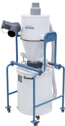
Das Bernardo FSG 1100 Feinstaub-Filtergerät ist ideal für den Einsatz bei Holzbearbeitungsmaschinen wie Dickenhobelmaschinen und Schleifmaschinen. Es ermöglicht das schnelle und einfache Wechseln des Spänesackes durch den ausfahrbaren Auffangbehälter. Das Gerät ist ohne eigenem Antrieb und kann mit Standard-Absauganlagen mit einer Motorstärke von mindestens 1,5 PS eingesetzt werden.
