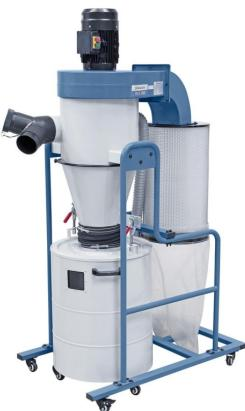
Die Reinluft-Absauganlage RLA 1800 verbessert durch die doppelte Spänefilterung (Zyklon bzw. Filterpatrone) die Leistungsfähigkeit ihrer Holzbearbeitungsmaschinen und hält daher den Arbeitsplatz späne- und staubfrei. Zusätzlich kann dieses Modell auch zum Absaugen von Kunststoffen, Papierstäubchen usw. eingesetzt werden.
