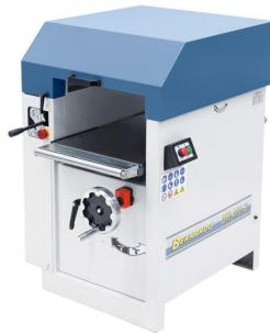
Die Bernardo DH 410 S / 400 V Dickenhobelmaschinen mit Spiralhobelwelle ist eine professionelle Lösung für präzise Hobelarbeiten. Durch die serienmäßige Spiralmesser-Hobelwelle wird die Lärmbelastung um ca. 50% reduziert und die Schneidenstandzeit kann bis zu 20-fach verlängert werden.
