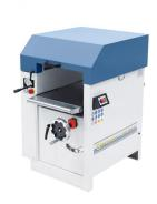
Die Bernardo DH 410 S / 400 V Dickenhobelmaschinen mit Spiralhobelwelle ist eine professionelle Lösung für die Holzbearbeitung. Mit einer Hobelbreite von 410 mm und einer Hobelhöhe von 5 bis 230 mm bietet sie eine hohe Flexibilität. Die Dickentischgröße beträgt 930\* x 410 mm und die Spanabnahme max. 5 mm.
