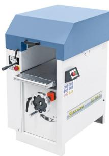
Die Bernardo DH 310 S / 400 V Dickenhobelmaschinen mit Spiralhobelwelle ist eine leistungsstarke Maschine für die Holzbearbeitung. Sie verfügt über eine Hobelbreite von 310 mm und eine Hobelhöhe von 5 - 230 mm. Die Maschine ist mit einer Spiralhobelwelle und 52 Stk. HM-Wendeplatten ausgestattet, was die Lärmbelastung um ca. 50% reduziert und die Schneidenstandzeit um bis zu 20-fach erhöht.
