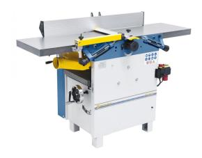
Die kompakte Abricht- und Dickenhobelmaschine PT 410 S - mit einem Dickendurchlass von 220 mm - ist ideal zum exakten Hobeln von Brettern, Leisten und Balken. Durch die optional erhältliche Langlochbohreinrichtung können zusätzlich Schlitz- und Bohrarbeiten durchgeführt werden. Die Spiralmesser-Hobelwelle für eine verminderte Lärmbelastung und optimale Hobelergebnisse ist ein weiteres Plus dieser Maschine.
