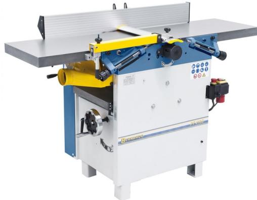
Die kompakte Abricht- und Dickenhobelmaschine PT 410 S - mit einem Dickendurchlass von 220 mm - ist ideal zum exakten Hobeln von Brettern, Leisten und Balken. Durch die optional erhältliche Langlochbohrreinrichtung können zusätzlich Schlitz- und Bohrarbeiten durchgeführt werden. Die Spiralmesser-Hobelwelle für eine verminderte Lärmelastung und optimale Hobelergebnisse ist ein weiteres Plus dieser Maschine.
