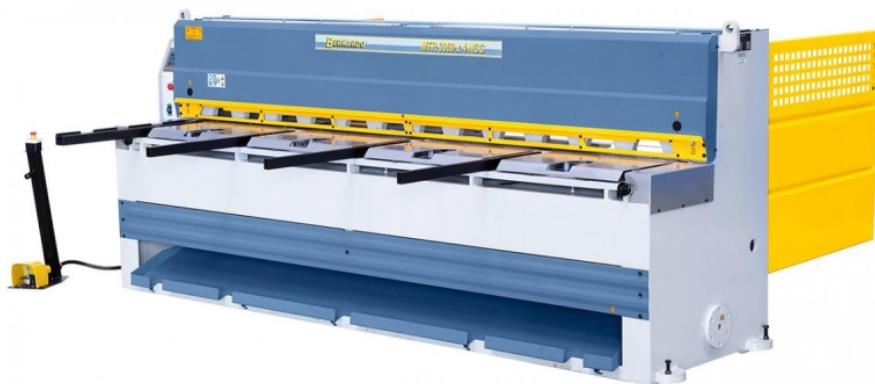
Die Bernardo MTR 1560 x 6 NCC Motorische Tafelscheren ist eine leistungsstarke Maschine zum Schneiden verschiedenster Materialien, wie z.B. Stahlblech, Messing, Aluminium, Kupfer usw. Die Maschine verfügt über eine Steuerung Fuji mit Touchscreen und einen motorischen NC-Hinteranschlag für erhöhte Sicherheit. Der Auflagetisch mit rechtwinkeligem Anschlag und Skala, Kippnocke und T-Nut für den optionalen Winkelanschlag ermöglicht präzises Arbeiten.
