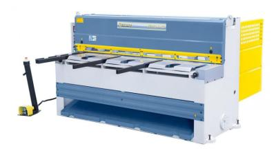
Die Bernardo MTE 3060 x 4 NCC Motorische Tafelscheren ist eine leistungsstarke Maschine für die Metallverarbeitung. Mit einer Schnittlänge von 3060 mm und einer maximalen Blechstärke von 4 mm ist sie ideal für verschiedene Anwendungen. Die Maschine verfügt über eine Arbeitshöhe von 800 mm und einen Hinteranschlag von 0 - 750 mm.
