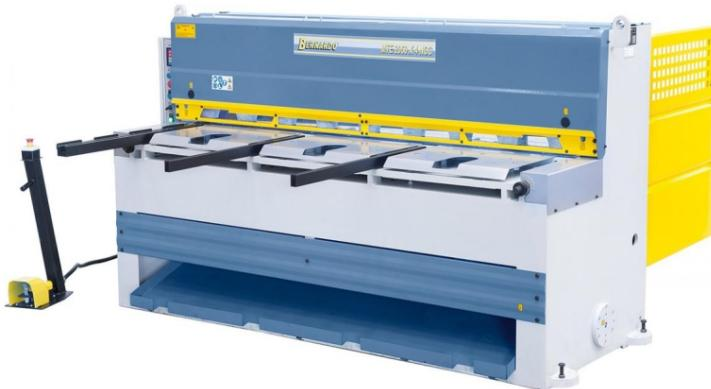
Die Bernardo MTE 3060 x 4 NCC Motorische Tafelscheren ist eine leistungsstarke Maschine zum Schneiden verschiedenster Materialien, wie z.B. Stahlblech, Messing, Aluminium, Kupfer usw. Die Maschine verfügt über einen motorischen Hinteranschlag, präzises Verfahren über Kugelumlaufspindeln und eine Tischauflagefläche mit integrierten Rollen, ideal für große Werkstücke.
