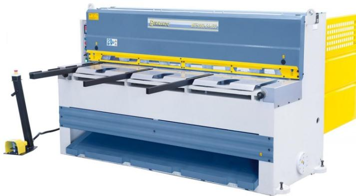
Die Bernardo MTE 2560 x 4 NCC Motorische Tafelscheren ist eine leistungsstarke Maschine zum Schneiden verschiedenster Materialien, wie z.B. Stahlblech, Messing, Aluminium, Kupfer usw.
