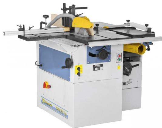
Die vielseitige Universal-Kombimaschine CWM 250 Top ist serienmäßig mit einem Rolltisch ausgestattet. Zusätzlich bietet dieses Modell durch das größere Sägeblatt einen Schnittbereich von 75 mm. Durch ihre kompakte Bauweise ist dieses Modell für den Hobbybastler und Heimwerker optimal geeignet.
