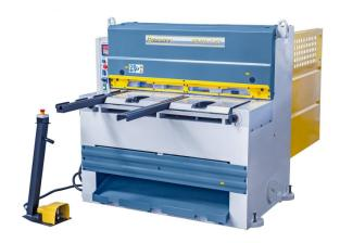
Die Bernardo MTE 1360 x 6 NCC Motorische Tafelscheren ist eine leistungsstarke Maschine für die Metallverarbeitung. Mit einer Schnittlänge von 1360 mm und einer Max. Blechstärke von 6 mm ist sie ideal für verschiedene Anwendungen.
