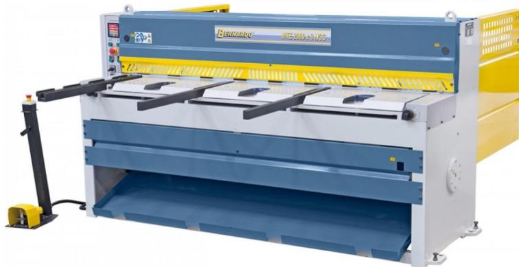
Die Bernardo MTE 2560 x 2,5 NCC Motorische Tafelschere ist eine leistungsstarke Maschine zum Schneiden verschiedenster Materialien, wie z.B. Stahlblech, Messing, Aluminium, Kupfer usw. Die Maschine verfügt über einen motorischen Hinteranschlag, der präzise über Kugelumlaufspindeln verfahren wird. Die Tischauflagefläche ist mit integrierten Rollen ausgestattet, ideal für große Werkstücke. Die 2-schneidigen Schnittmesser aus Qualitätsstahl garantieren ein sauberes und grätfreies Schneiden.
