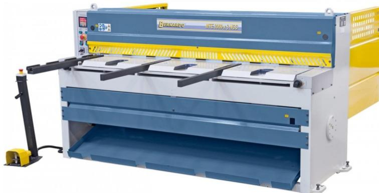
Die Bernardo MTE 2060 x 3 NCC Motorische Tafelscheren ist eine leistungsstarke Maschine zum Schneiden verschiedenster Materialien, wie z.B. Stahlblech, Messing, Aluminium, Kupfer usw. Die Maschine verfügt über eine motorische Tafelblechscher, einen motorischen Hinteranschlag und eine Tischauflagefläche mit integrierten Rollen.
