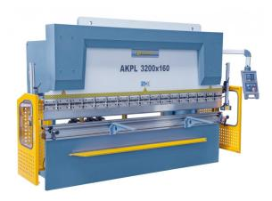
Die Bernardo AKPL 3200 x 160 mit manueller Bombiereinrichtung Hydraulische Abkantpressen ist ein leistungsstarkes Werkzeug für die Metallverarbeitung. Mit einer Druckkraft von 160 to und einer Abkantlänge von 3200 mm ist sie ideal für das Biegen und Formen von Metallteilen.
