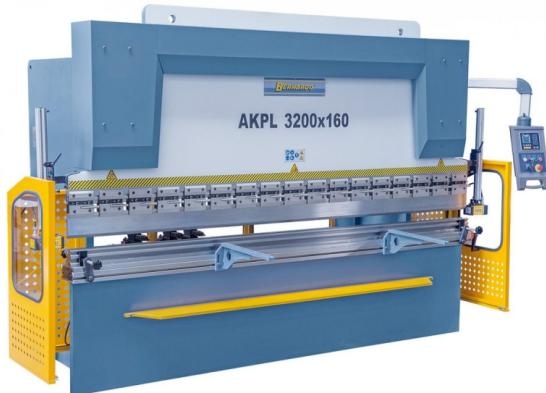
Die Bernardo AKPL 3200 x 160 mit manueller Bombiereinrichtung Hydraulische Abkantpressen ist ein leistungsstarkes Werkzeug für die Metallverarbeitung. Mit einer Druckkraft von 160 to und einer Abkantlänge von 3200 mm ist sie ideal für das Biegen und Formen von Metallteilen.
