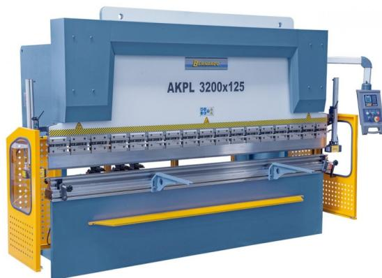
Die Bernardo AKPL 3200 x 100 Hydraulische Abkantpresse ist ein leistungsstarkes Werkzeug für die Metallverarbeitung. Mit einer Druckkraft von 100 to und einer Abkantlänge von 3200 mm ist sie ideal für das Biegen von Metallplatten. Die Maschine verfügt über eine Vorlaufgeschwindigkeit von 90 mm/s und eine Biegeschwindigkeit von 8 mm/s.
