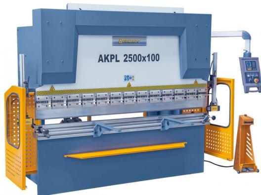
Die Bernardo AKPL 2500 x 100 Hydraulische Abkantpresse ist eine leistungsstarke Maschine für die Metallverarbeitung. Mit einer Druckkraft von 100 t und einer Abkantlänge von 2500 mm ist sie ideal für die Bearbeitung von großen und schweren Werkstücken.
