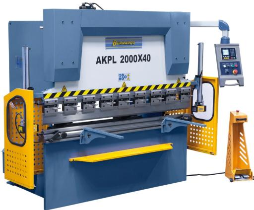
Die Bernardo AKPL 2000 x 40 Hydraulische Abkantpresse ist ein leistungsfähiges Werkzeug für die Metallverarbeitung. Mit einer Druckkraft von 40 t und einer Abkantlänge von 2000 mm ist sie ideal für das Biegen von Metallplatten. Die Abkantpresse verfügt über eine Hinteranschlag von 0 - 500 mm und eine Ausladung von 200 mm.
